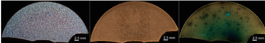
暗視野と蛍光観察の追加で、結晶成長の欠陥ムラ等を発見しやすい。
