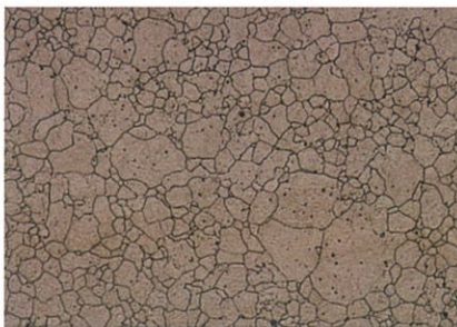
SCM415 浸炭・焼入焼戻組織・硬化層 (x50)
