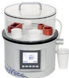
図 6: 真空含浸装置 ポリバック
