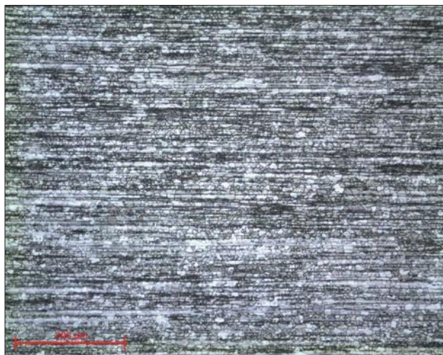
Fig. 26: Aluminum 2024 CS lensx10
