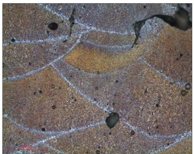
顕微鏡写真 26: アルミ合金 SPM で最終仕上げ ケラー試薬でエッチング 対物 20x
