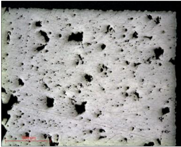
顕微鏡写真 10: アルミニウム合金 - NT 1μm 対物 5x
