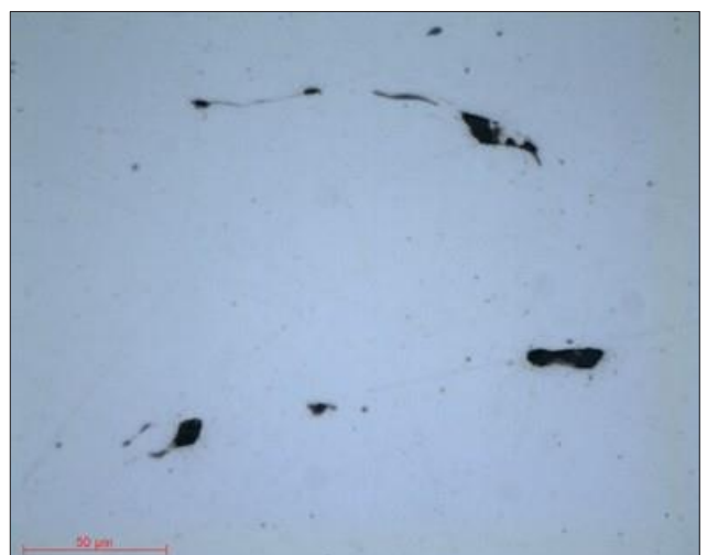
顕微鏡写真 20: コバルトクロム合金 1 \mu m まで研磨 対物 50x
