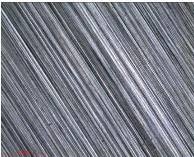
顕微鏡写真 4: コバルトクロム合金 - 耐水研磨紙 P320 対物 5x
