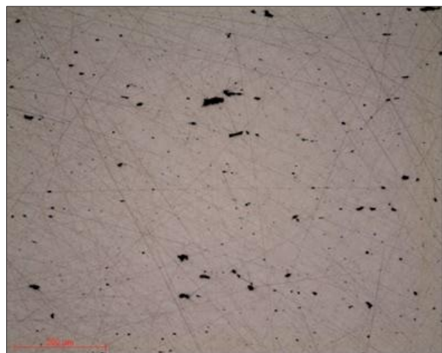
顕微鏡写真 5: コバルトクロム合金 TOP 9μm 対物 5x
