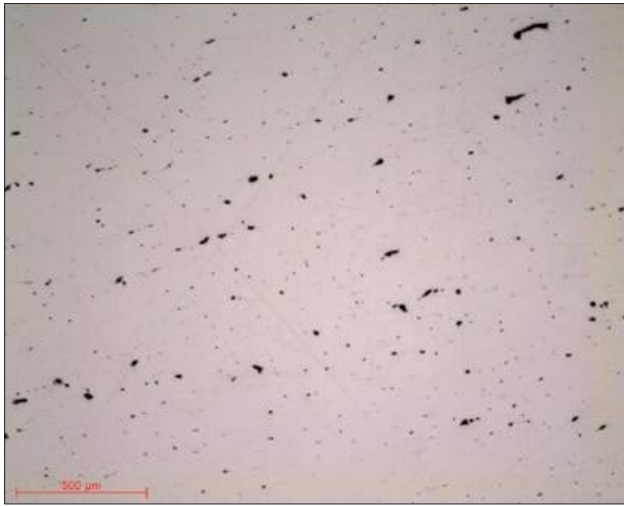
顕微鏡写真 6: コバルトクロム合金 RAM 3µm 対物 5x
