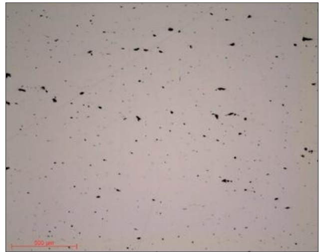
顕微鏡写真 7: コバルトクロム合金 NT 1µm 対物 5x
