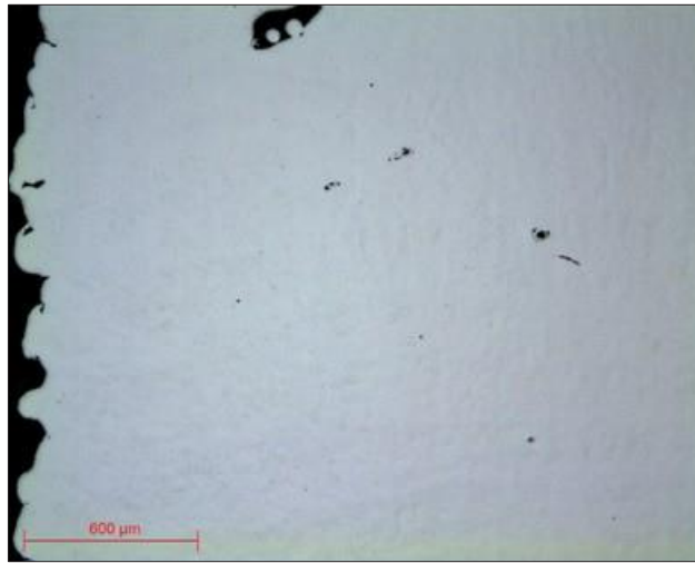
顕微鏡写真 14: チタン合金- SUPRA SPM で最終仕上げ 対物 5x
