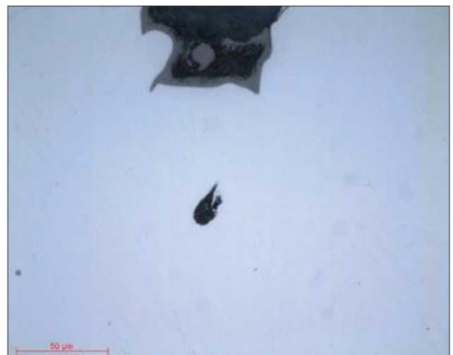
顕微鏡写真 17 及び 18: チタン合金 SPM で最終仕上げ 対物 20x
