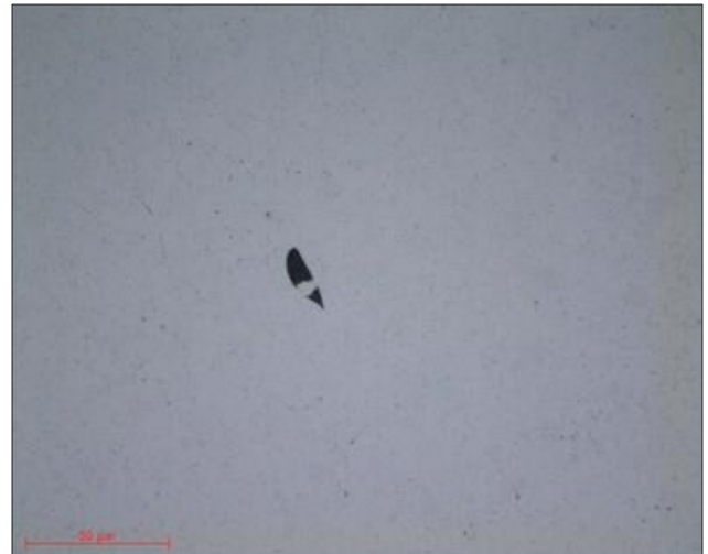
顕微鏡写真 16: 耐食鋼 1 \mu m まで研磨 対物 50x
